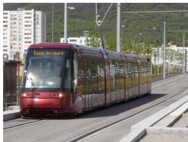
Figure 12 : Roulement pneumatique - Tramway de Clermont-Ferrand, France
